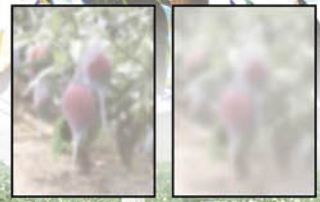
パールメイトST 梨地農ビ フィルムの後方約30cmでの作物の見え方の差(0.1mm厚)
